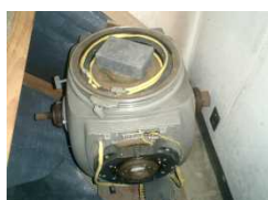
しゃへい体 (劣化ウラン)
